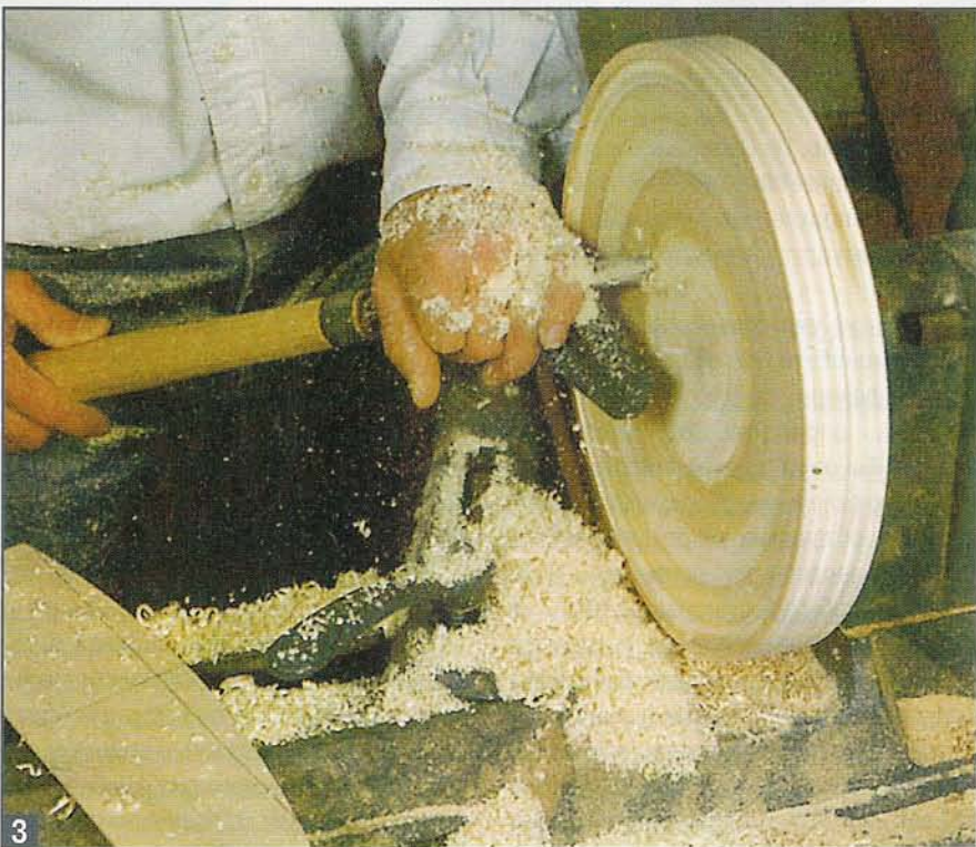
3 Основание выточено из фанеры. Шаблон (лежит на станине) помогает сформировать полость в основании.
